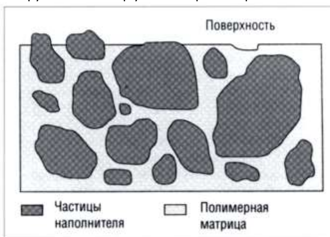
Рис.2.2.19. Частицы наполнителя выступают над поверхностью из-за преимущественного удаления полимерной матрицы
