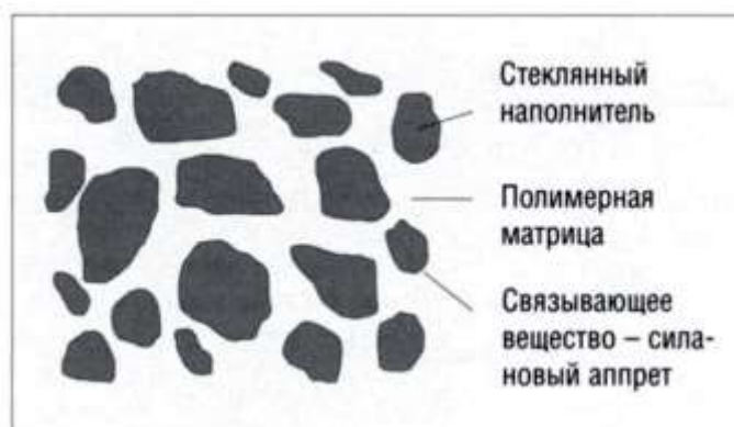
Рис.2.2.1. Структура композитных восстановительных материалов
