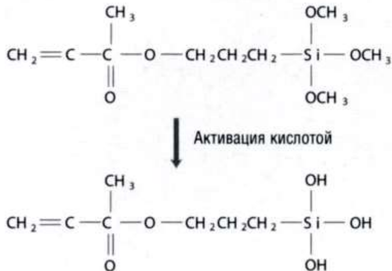
Рис. 2.2.3. Структура силанового аппрета до и после активации кислотой
