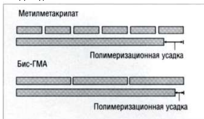
Рис.2.2.2. Полимеризационная усадка материалов на основе малых и больших мономеров
