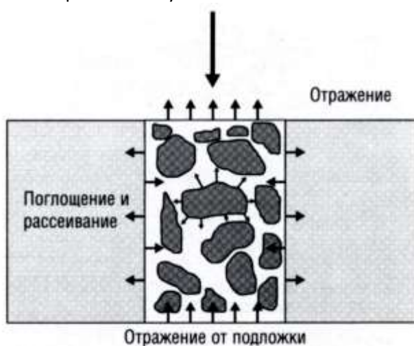
Рис.2.2.10. Отражение, рассеивание и поглощение света при облучении им композита
