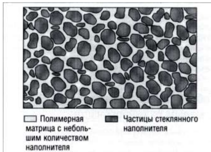
Рис. 2.2.22. Структура гибридного композита, состоящего из больших частиц наполнителя в полимерной матрице, содержащей коллоидный оксид кремния
