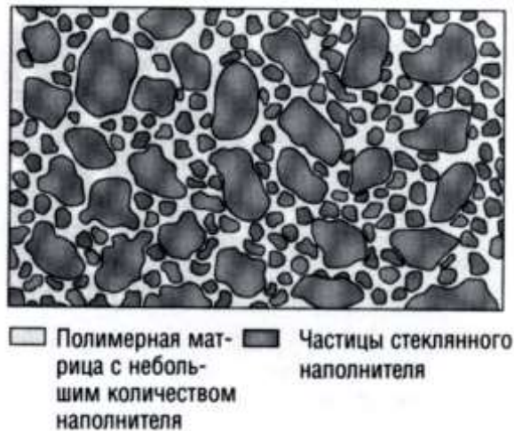
Рис. 2.2.25. Бимодальное распределение частиц по размеру
