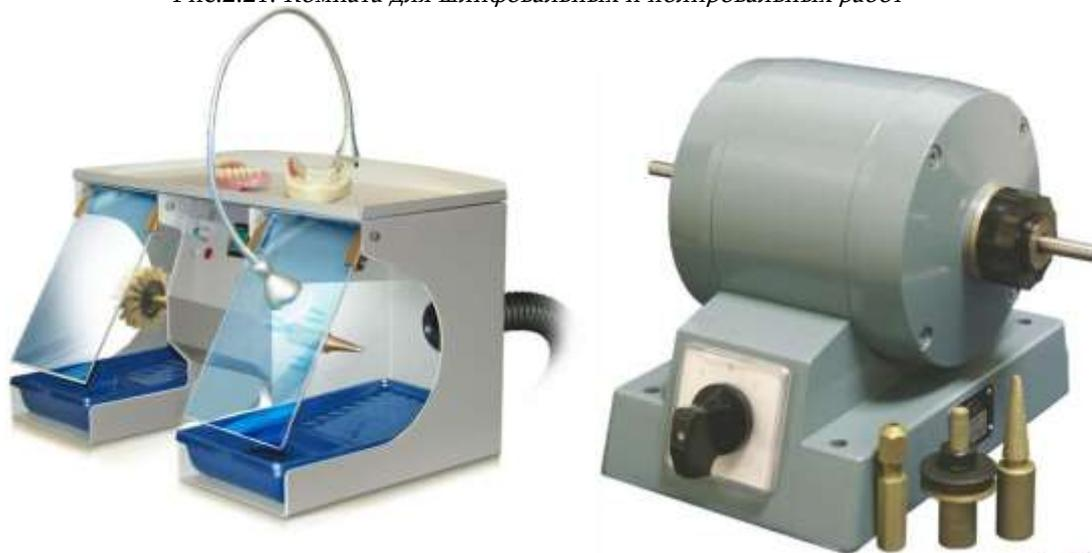
Рис.2.22. Аппараты для шлифования и полирования протезов и их полуфабрикатов
