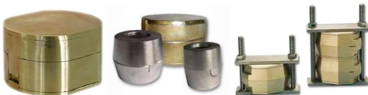
Рис.2.11. Латунные кюветы (а, б), фиксированные в алюминиевом зажиме (бюгеле) (в)
