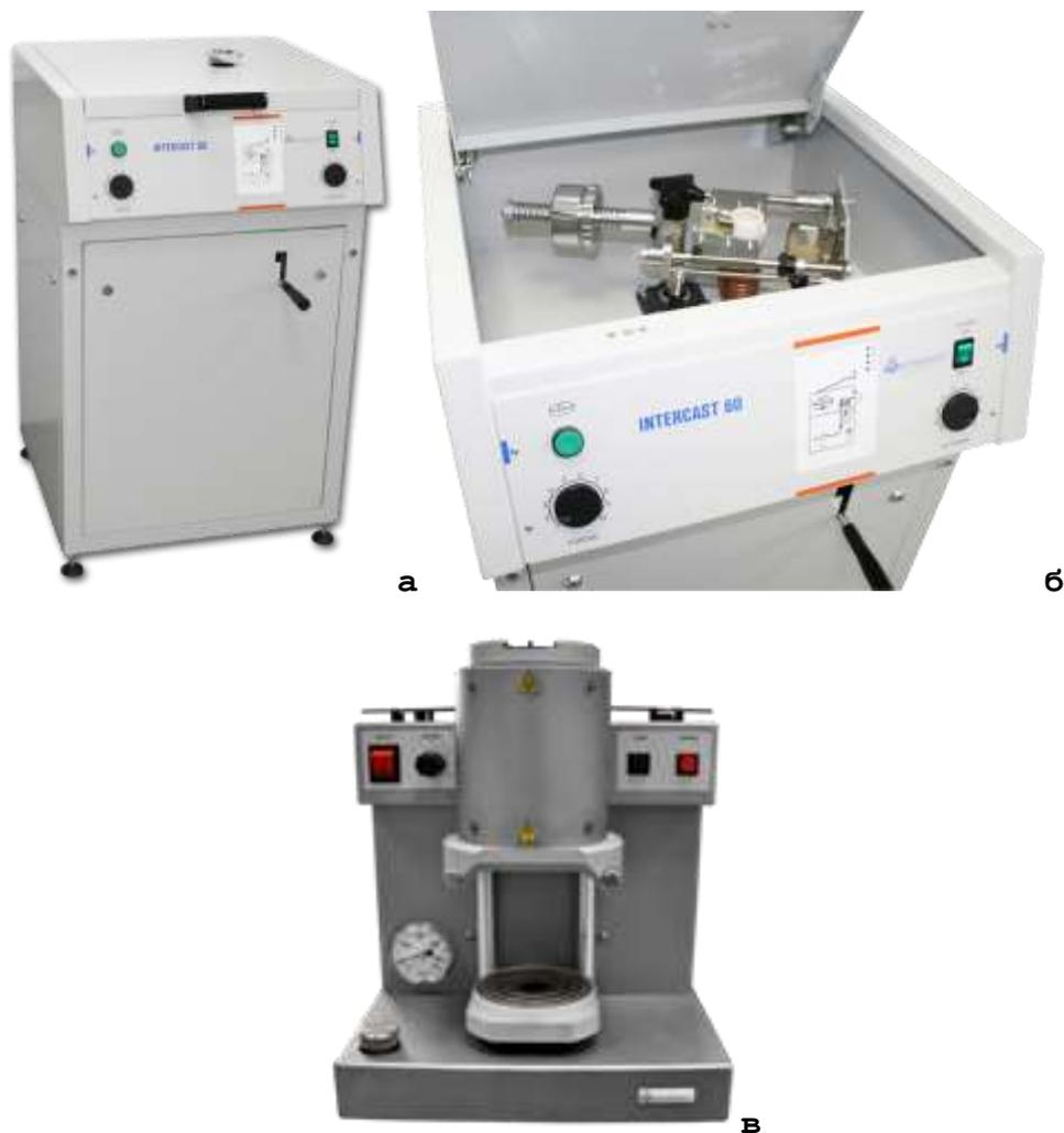
Рис.2.26. Литейная установка с центрифугой (а - внешний вид; б - рабочая камера) и вакуумно-индукционная установка (в)
