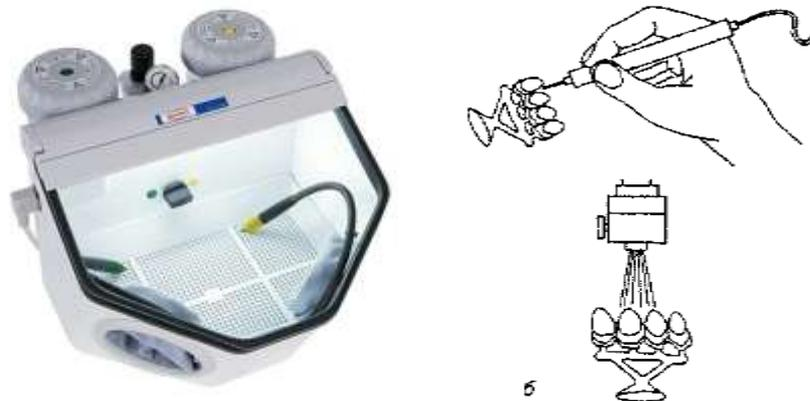
Рис. 2.5. Пескоструйная установка (а) и схема (б) пескоструйной обработки литого каркаса несъемного протеза оксидом алюминия разной степени зернистости
