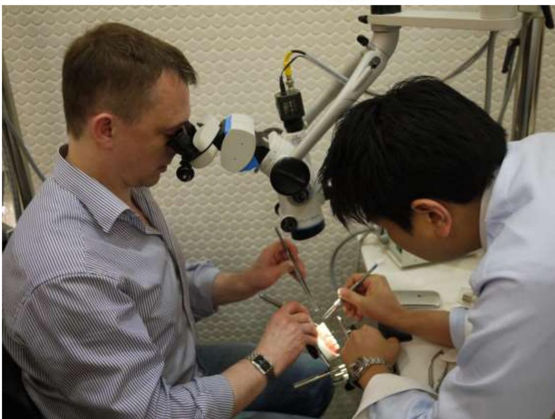
Рис.2.37. Стереомикроскоп со штативом (а), обеспечивающий 5-10-кратное увеличение.
