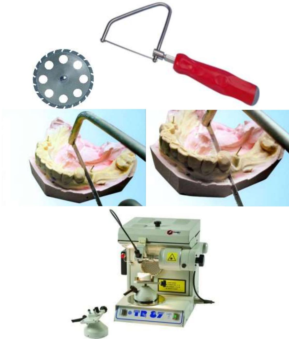
Рис.2.15. Отрезные диски (а), угловой лобзик (б) и прибор с дисковой пилой (в) для работы с гипсовыми моделями челюстей
