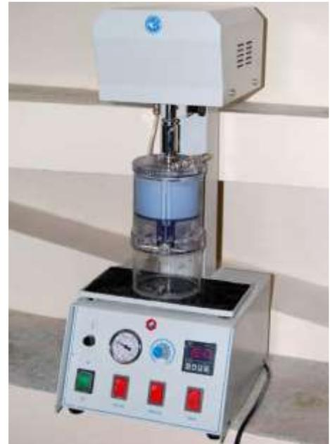
Рис. 2.4. Вакуумный смеситель
