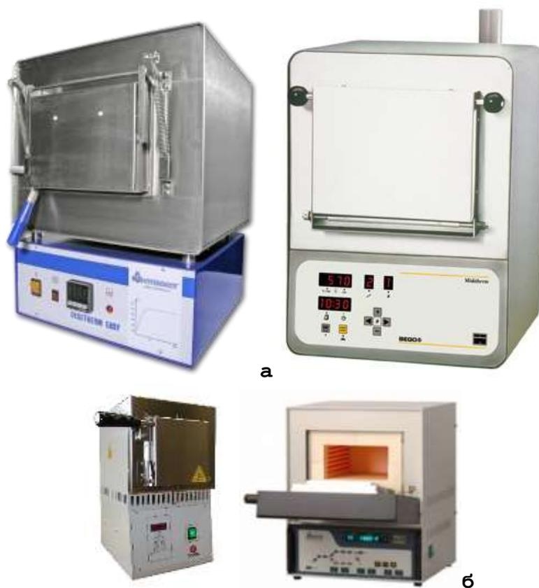
Рис.2.27. Внешний вид (а) и рабочая камера (б) муфельных печей
