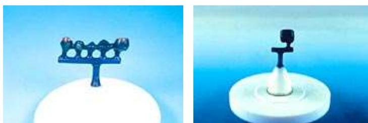
**Рис. 3.5.** Восковая композиция титанового каркаса протеза и литниковой системы.
