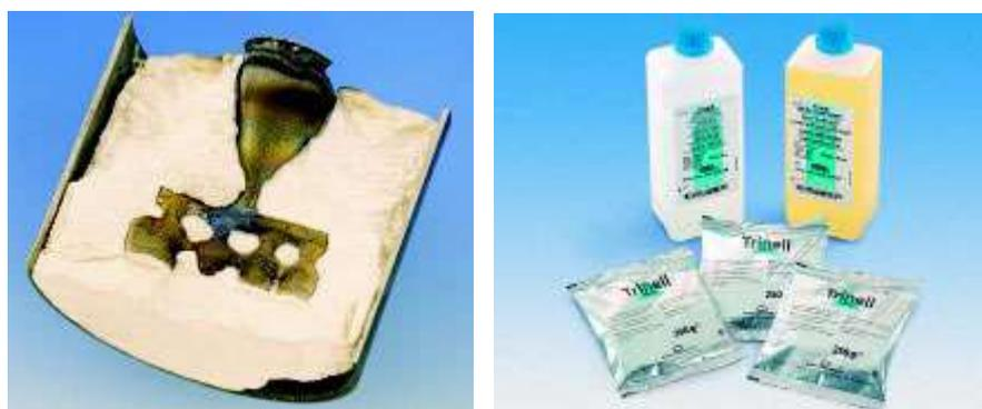
**Рис. 3.4.** Паковочная масса *Рематитан-Ультра*: а – каркас мостовидного протеза в опоке; б – фабричная упаковка материала.
