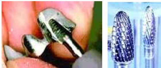
**Рис. 3.6.** Фрезы (б) для обработки каркаса (а) из титана.
