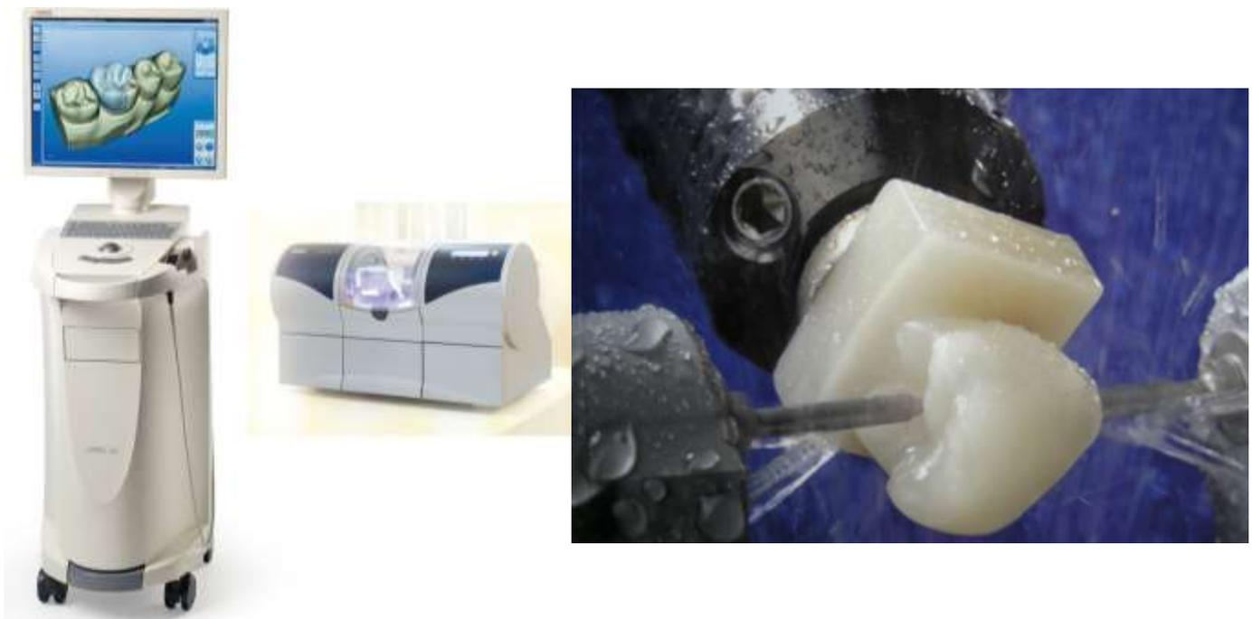
**Рис.4.8.** Получение вкладки фрезерованием из стандартной керамической заготовки (система CEREC)
