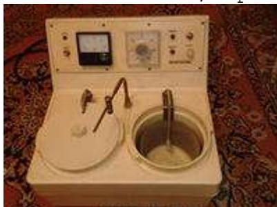
Рис. Аппарат для электрохимической полировки «Катунь»
