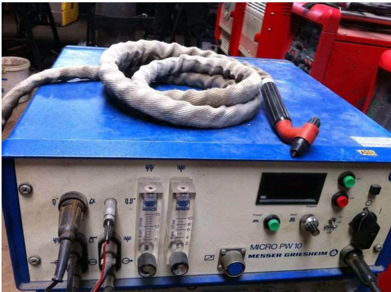
**Рис.** Установка для микроплазменной сварки Микро-РВ 10.
