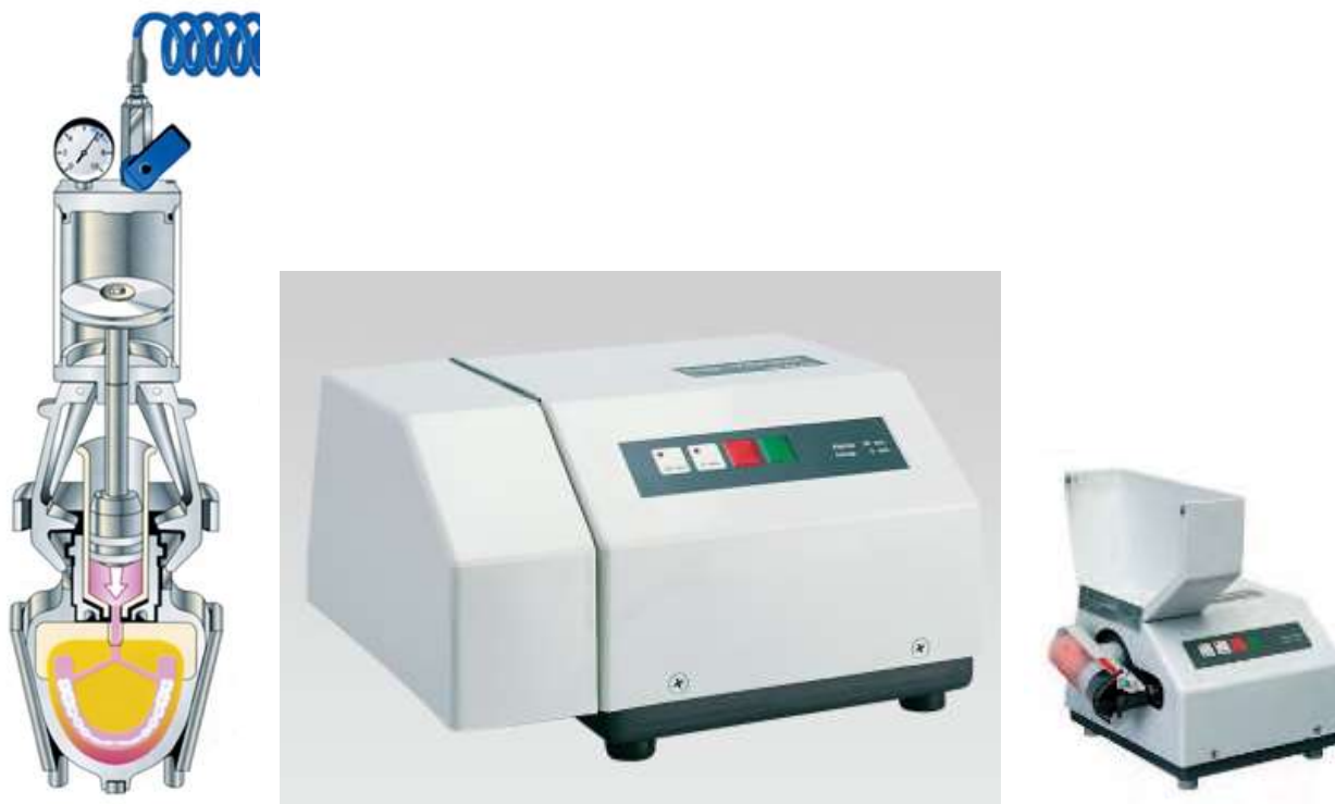
Рис.20 Метод инъекционно-литьевого прессования пластмассы: а-схема; б-смеситель пластмасс (система Ивокап)
