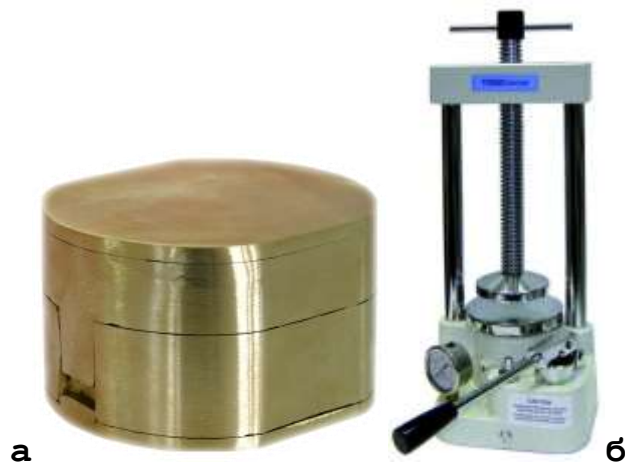
Рис.18. Латунная кювета (а) и гидравлический пресс для кювет (б)
